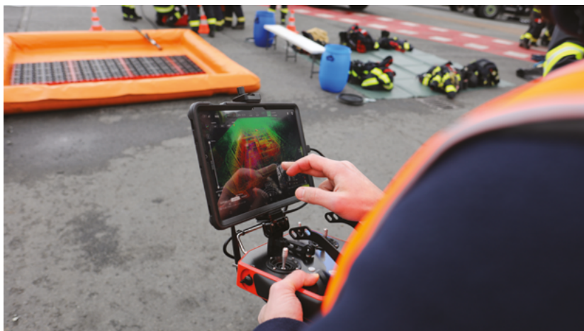
Obr. 2: Pohled do rozhraní pilota, který za pomoci lidarů prolétá objekt zamořený únikem jedovatých par a hledá místo úniku
