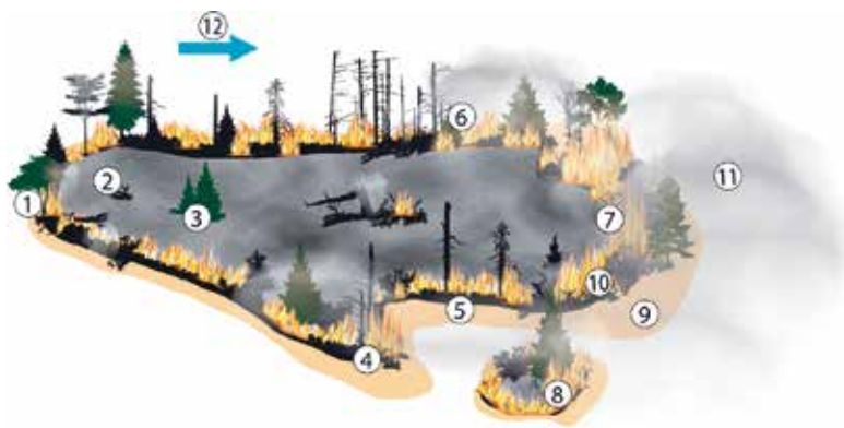
Anatomie lesního požáru: 1 – tyl požáru, 2 – ohnisko požáru, 3 – ostrov, 4 – prst požáru, 5 – pravé křídlo, 6 – levé křídlo, 7 – čelo požáru, 8 – bod požáru, 9 – pásmo přípravy hoření, 10 – pásmo hoření, 11 – pásmo zadýmení, 12 – směr větru (převzato z: Pecl J. et al. 2021).
